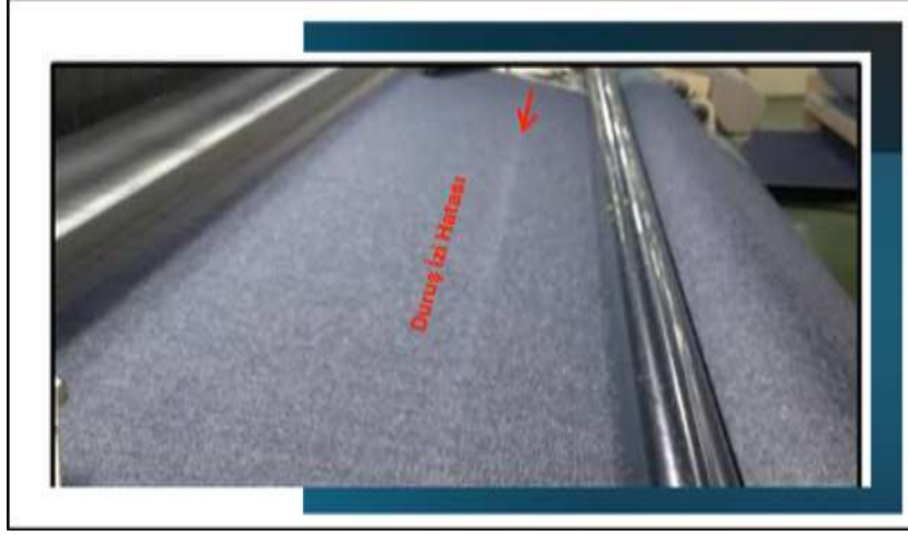
Şekil1. Dokuma kumaşlarda duruş izi hatası
