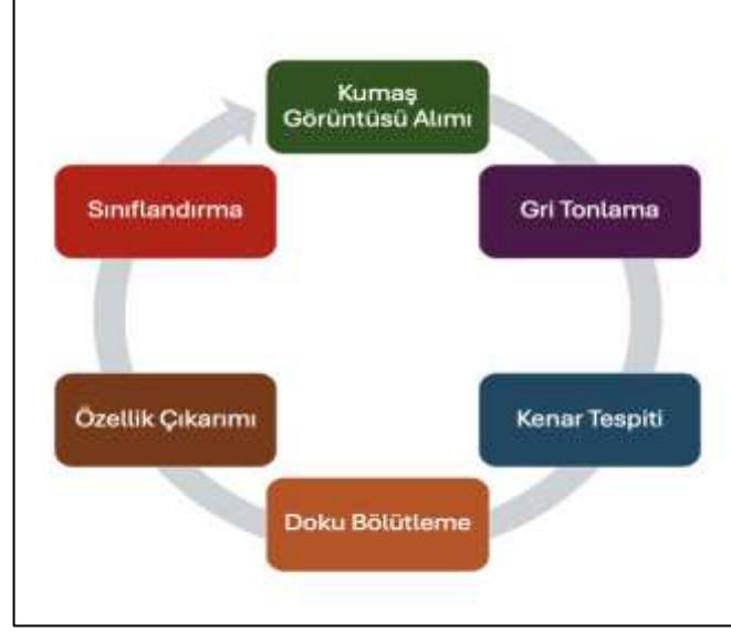
Şekil 5. Duruş izi tespitinde kullanılan görüntü işleme adımlarının döngüsel akış diyagramı
