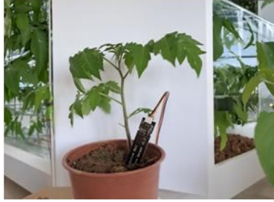
Şekil 3. Domates bitkisinde kapasitif tipteki nem sensörünün kullanımı
