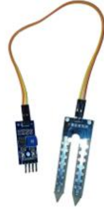
Şekil 2. Domates bitkisinde rezistif tipteki nem sensörünün kullanımı
