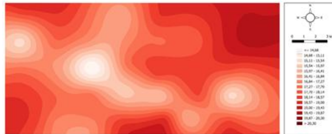
Şekil 5. Yer yüzeyine 30 derece eğimle B3 noktasında bulunan Şehir merkezine doğru yönlendirilmiş SQM cihazı ile alınan ölçümler CBS yöntemleri ile ışık kirliliği haritasına dönüştürülmüştür
